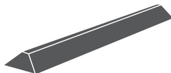
Die Flächen der taktilen Buchstaben der eingesetzten Schwarzschrift müssen sich von der Buchstabenbasis bis zur oberen Tastkante verjüngen und pyramidenförmig verlaufen. Somit entsteht ein schmaler Grad an der Tastfläche, der sehr gut zu ertasten ist. Die Basisbreite und die optimale Höhe der Buchstaben können der aktuellen DIN entnommen werden.
